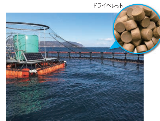
魚の食欲に応じてエサを与える「アクアリンガル®」給餌システム
